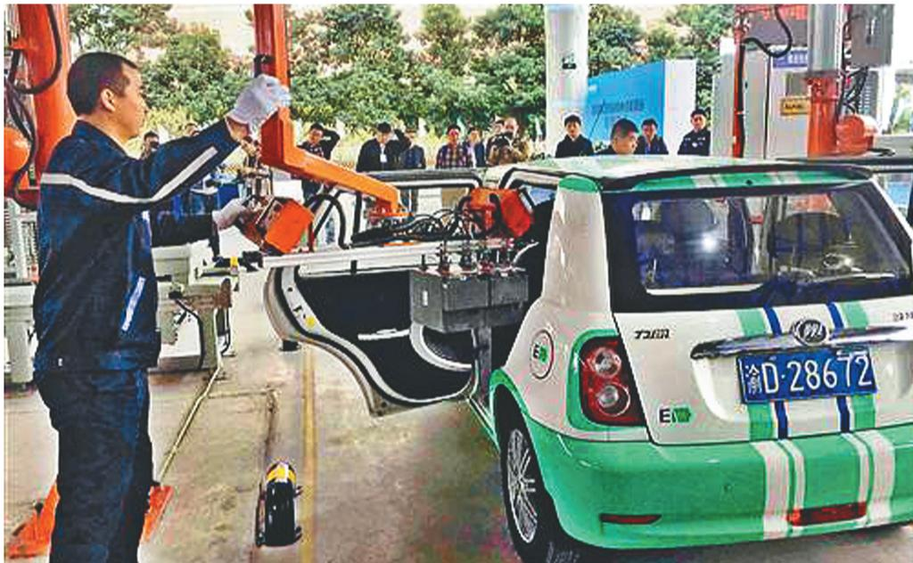
移峰能源首座集中式新能源站正式启用,工作人员正在演示为新能源汽车更换电池。
