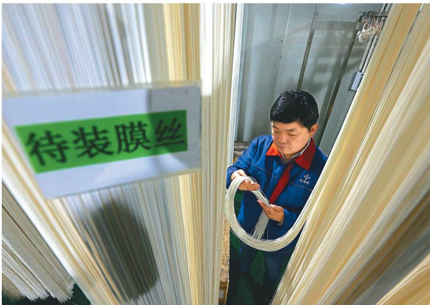
近日,长寿区重庆云天化瀚恩新材料开发有限公司,员工正对自主创新研发的中空纤维超滤膜进行初检。
